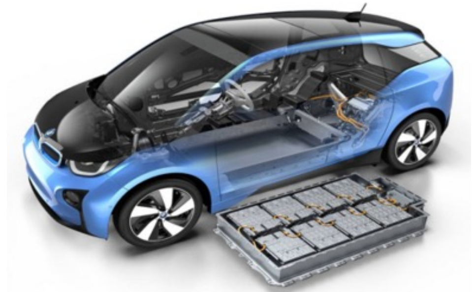
Abb. 1a: BMW i3 mit LiB-Block (Foto: Prospektmaterial BMW AG München)
